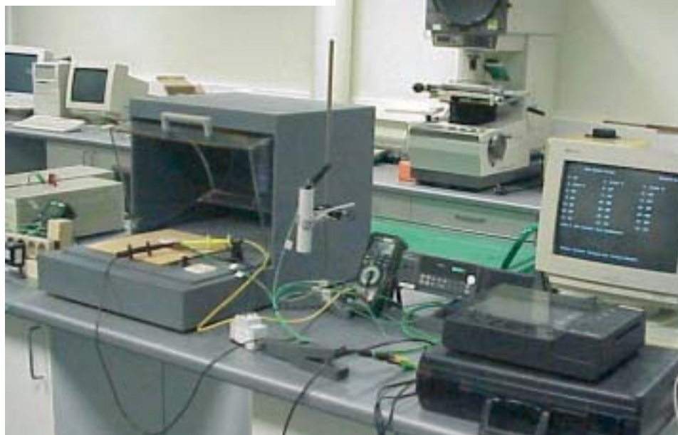
Vooraan: de test van GSM-batterijen, achteraan: de profielprojector
