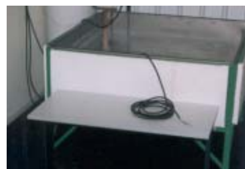
De kuip waarin de kabels ondergedompeld worden
